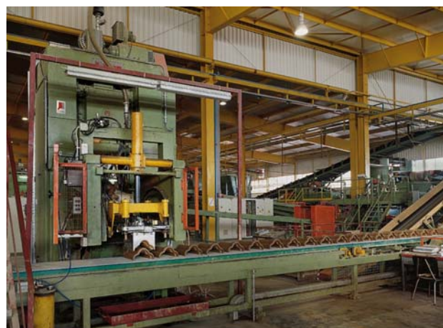
15PV type mechanical press for special pieces Pressa meccanica per pezzi speciali tipo 15PV
