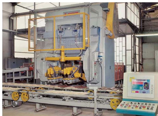
Crono 222 type 2-mould mechanical press Pressa meccanica a 2 stampi tipo Crono 222
